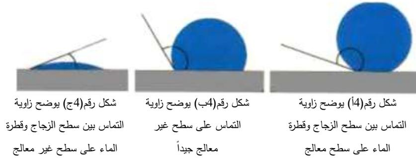
وتختلف عن طلاءات ملمس اللوتس في أن السطح لها أملس ويختلف عن الدهانات الكهروضوئية في أن جريان المياه عليها في صورة نقط لا في شكل طبقات رقيقة.
