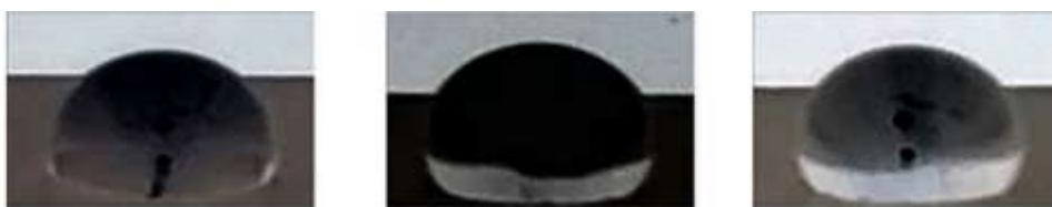
شكل رقم (22) (أ) يوضح شكل قطرة الماء على السطح بعد غمس الشرائح عدد 15 مرات      شكل رقم (22) (ب) يوضح شكل قطرة الماء على السطح بعد غمس الشرائح عدد 20 مرات      شكل رقم (22) (ج) يوضح شكل قطرة الماء على السطح بعد غمس الشرائح عدد 10 مرات
